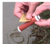
顶盖上拔下。清洗滤芯：滤芯的出水口朝上，用配的砂纸（没有砂纸时用树叶、水草、粗砂也可以）清洗滤芯表面，将滤芯表面的污染物擦掉露出新的表面，冲洗干净，再装回滤芯和主体顶盖即可。
