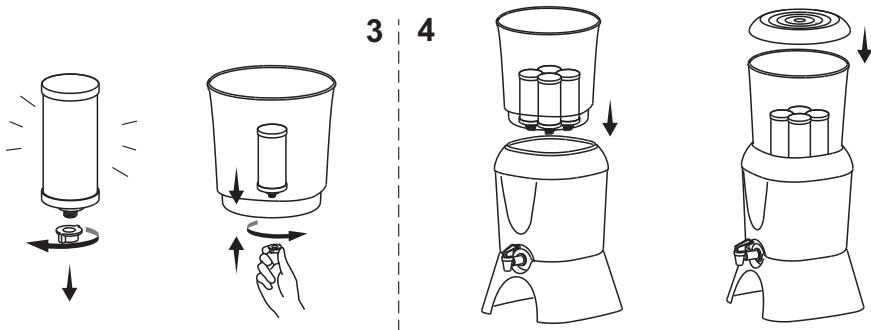
重力净水桶所用的滤芯是可更换的。当您使用的滤芯达到使用寿命或破损时，请及时更换新的滤芯：将上桶的水倒掉，旋下蝶形螺母，拆下旧滤芯，从包装中取出新的滤芯装到净水桶上即可。
